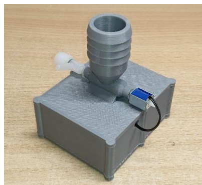
Рисунок 4 – Модель и реальный образец клапанного узла
