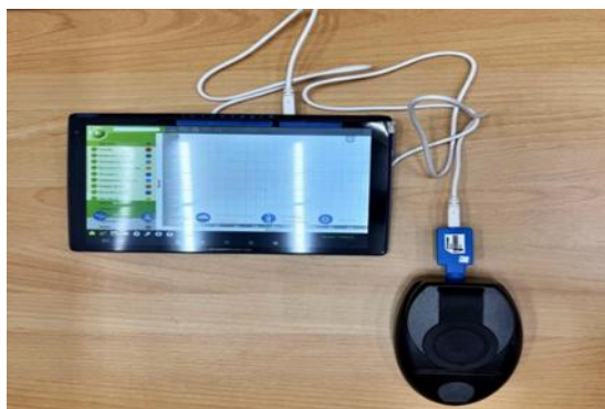
Рис. 2. Датчик мутности DT095A (турбидиметр), подключенный к цифровой лаборатории
