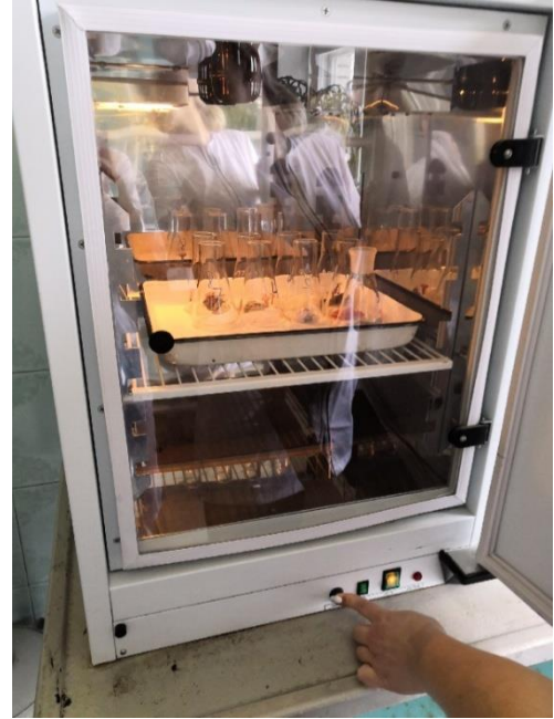
Рисунок3- Приготовление водных вытяжек исследуемых образцов с использованием термостата ТС/80 СПУ
