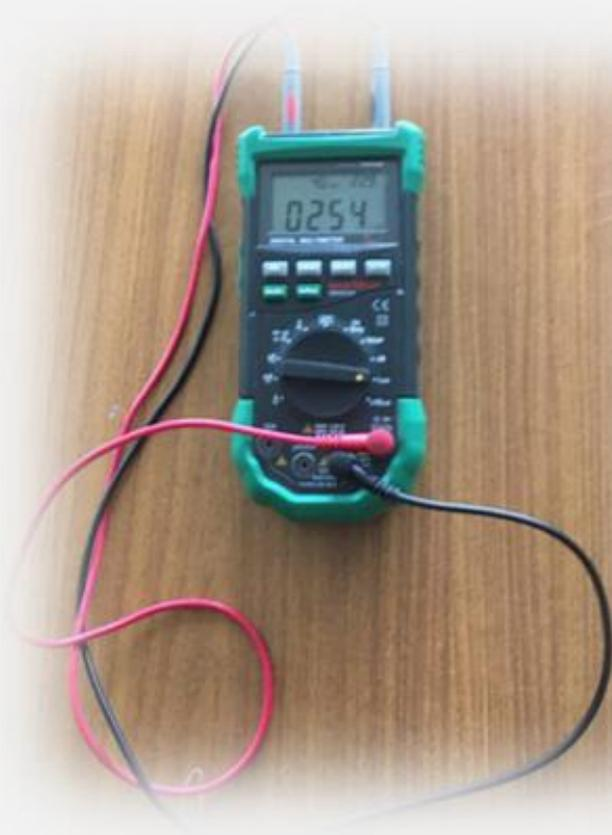
Люксметр – это прибор, который используется для измерения уровня освещенности. Принцип работы люксметра основан на явлении фотоэлектрического эффекта. Свет, при попадании на полупроводниковый фотоэлемент, передает свою энергию электронам. В результате происходит высвобождение электронов в объеме полупроводника, вследствие чего через фотоэлемент начинает проходить ток. Величина силы тока пропорциональна освещенности фотоэлемента. Единица измерения освещенности называется люкс
