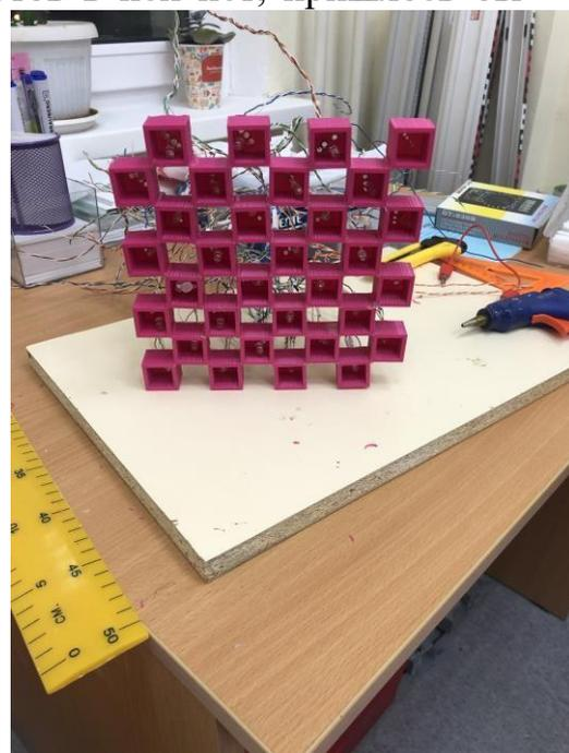
Третья версия проекта— это то, что мы вам представляем. Набор адресных светодиодов на лично изготовленной плате. Теперь нет ни большой массы проекта, ни больших скруток проводов. Плата со светодиодами весит порядка 150-ти грамм, проводов всего три, и все они лишь для подключения питания- плюсовой и минусовой провода, и контролирующей провод.
