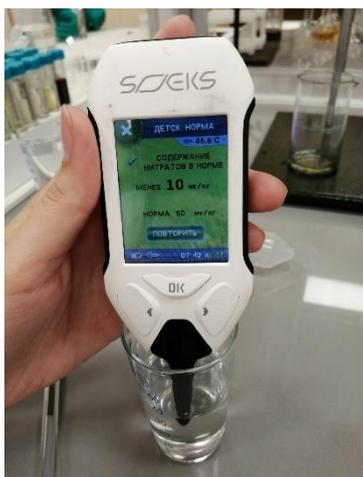
Определение содержания нитратов в пробах воды
