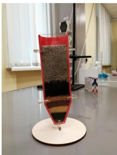
Макет фильтровальной установки на основе металлургического шлака
