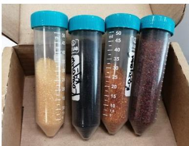
Ионообменные смолы, один из компонентов фильтровальной установки для доочистки воды
