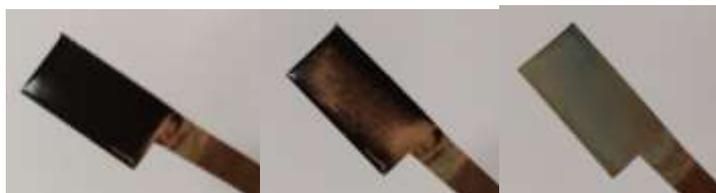
**Рис. 13. Высыхание пластинки после электролиза**
