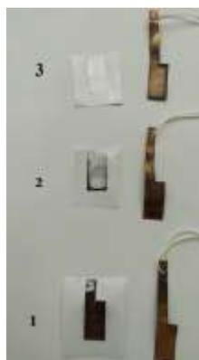
**Рис. 8. Патинирование парами серы. 1- горячие пары, 2- остывшие, 3- частично сконденсированные**
