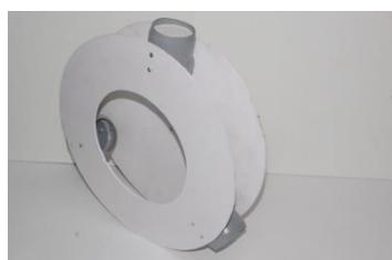
Само колесо состоит из 2х обручей из пластика внешним диаметром 30 см. Один обруч имеет внутреннее отверстие диаметром 16 см. Между обручами с помощью винтов (0.3x1.6) крепятся 3 грунтбокса, угол между
