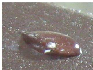
Рисунок 3-Скатывание капли воды на поверхности, обработанной антиобледенительным составом
