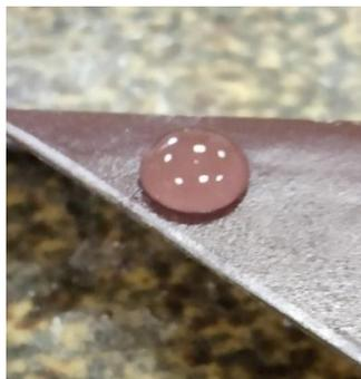
Рисунок 6 -Капля воды на обработанном металле антиобледенительным составом, подвергавшемуся 55 циклам попеременного замораживания и оттаивания
