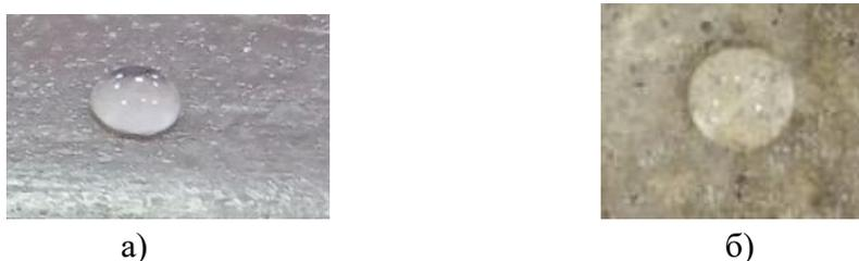
Рисунок 2 - Капля воды на поверхности, обработанной антиобледенительным составом:
