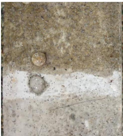
Рисунок 7 – капля воды на антиобледенительном составе, нанесенном на бетонную подложку (сверху), капля воды на необработанной бетонной подложке (снизу)
