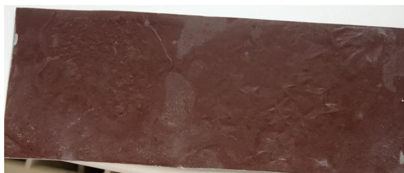
Рисунок 5 - Заможенная в морозильной камере вода на необработанной поверхности металла
