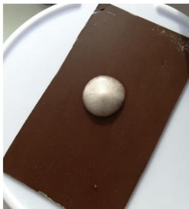
Рисунок 4 - Заможенная в морозильной камере вода на поверхности, обработанной антиобледенительным составом
