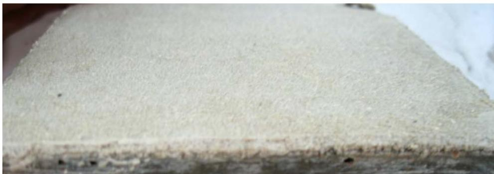
Рисунок 6 – внешний вид покрытия на основе разработанной сухой строительной смеси
