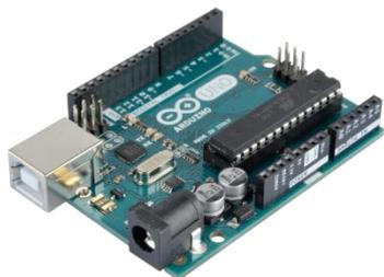
Аппаратная вычислительная платформа с микроконтроллером, основными компонентами которой являются микроконтроллер ATmega328, устройство ввода-вывода и среда разработки. Arduino, применяется для создания электронных устройств с возможностью приема сигналов от различных цифровых и аналоговых датчиков, которые могут быть подключены к нему, и управления различными исполнительными устройствами.
