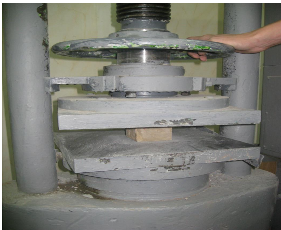
Фото 7. Вид образца, находящегося под давлением прессы.
