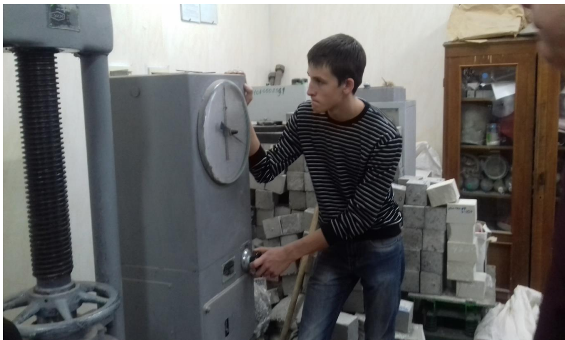
Фото 6. Определение прочности бетона при сжатии на пресс-установке
