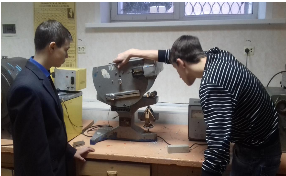
Фото 5. Определение прочности бетона при изгибе
