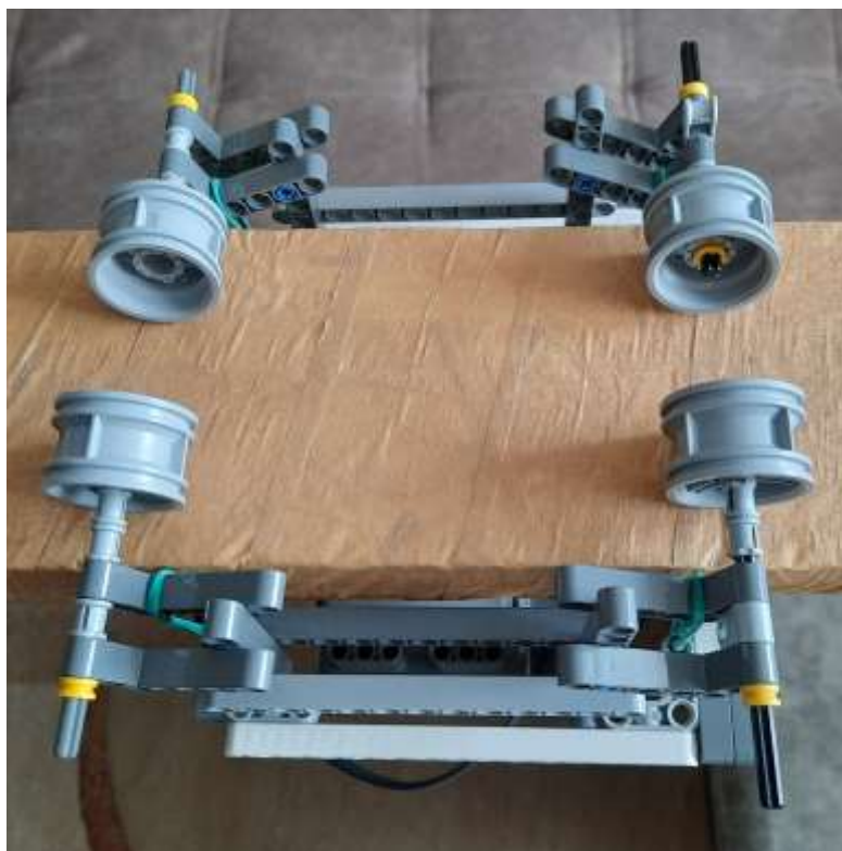
Рис. 12. Фотография катков с внутренней стороны монорельса.
