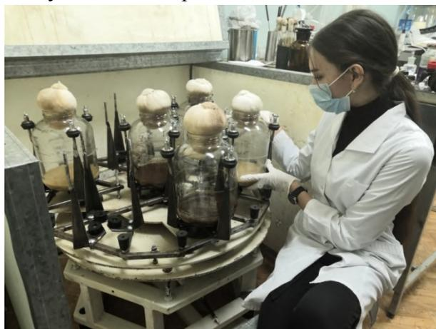
**Рисунок 7** – Культивирование глубинной культуры микроорганизмов на микробиологической качалке
