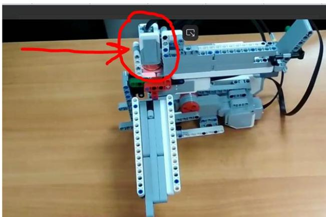
• После распознавания, робот поворачивает выпускной желоб и направляет монету в соответствующий контейнер. Для этого используется ещё один большой мотор.
