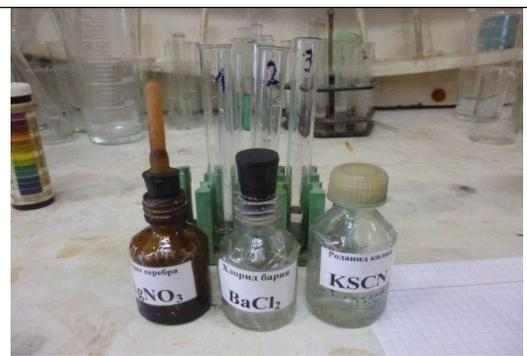
Фото 8 Исследование водопроводной воды на содержание ионов.
