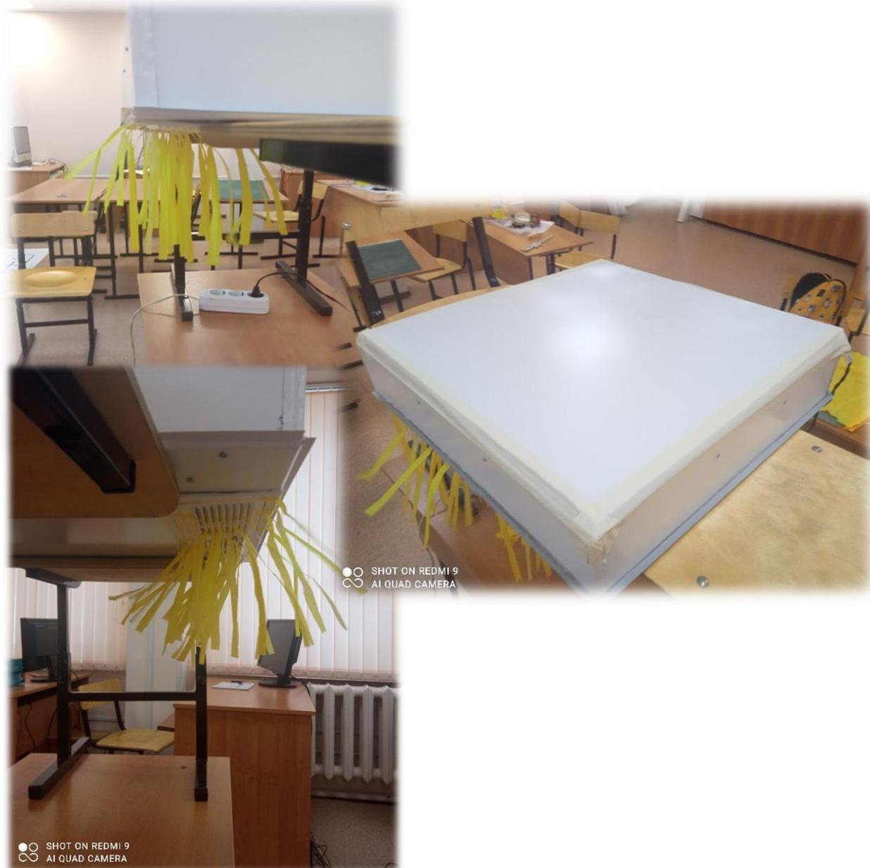
Таким образом, по результатам проведенного эксперимента по визуализации распределения воздушных потоков на выходе из рециркулятора SBAC следует произвести его модернизацию выходных отверстий:
