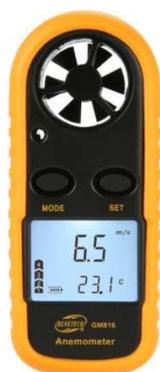
В последнее время, большое распространение получили цифровые крыльчатые анемометры. Скорость потока в данном анемометре измеряется с помощью круглой крыльчатки с несколькими лопастями. Поток воздуха, воздействуя на крыльчатку вращает её с определённой скоростью. Измерив скорость вращения крыльчатки, определяется скорость движения потока. Крыльчатка или встроена в прибор, либо вынесена за пределы прибора. Портативный крыльчатый анемометр, это электронный прибор небольшого размера с
