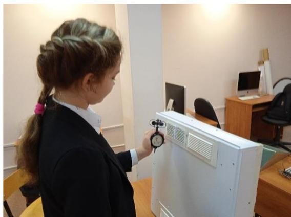
Измерение скорости потоков воздуха для SBAC
