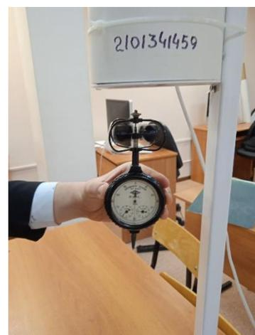
Измерение скорости потоков воздуха для Solar 60 и МСК 908
