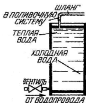
Рис.6. Устройство для подогрева воды с использованием запорного вентиля.
