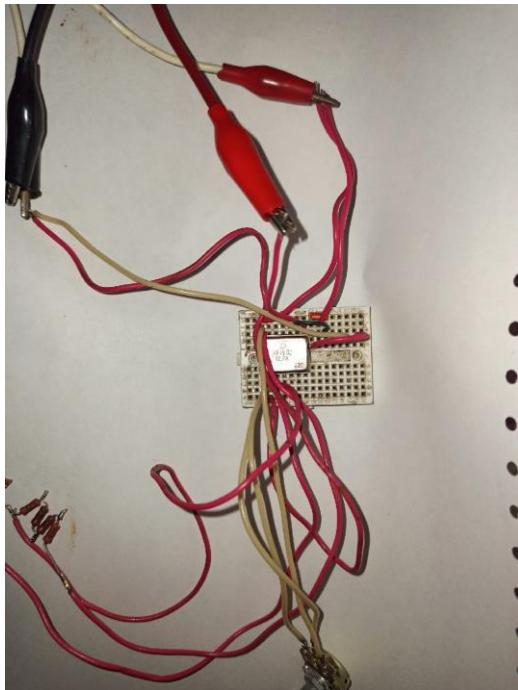
*Система контролирования влажности почвы собранная на макетной плате*
