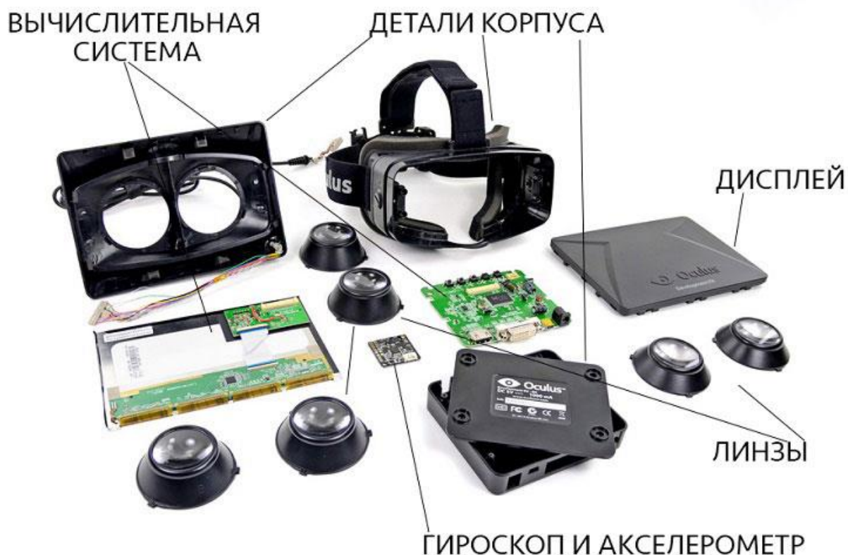
Рисунок 3 – Устройство очков виртуальной реальности
