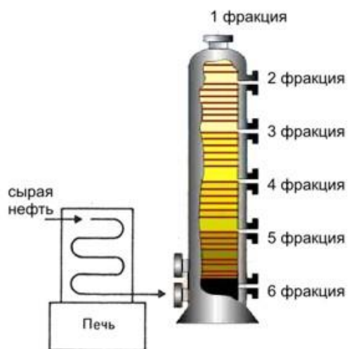
Рисунок 1. Схема устройства для фракционной дистилляции
