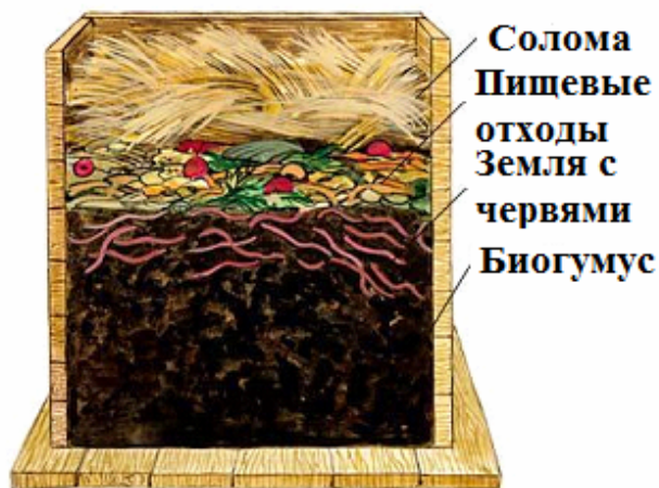
Рис. 1.2. Устройство домашнего червячника.
