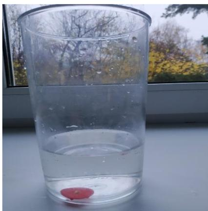
Нальем в стакан воду и опустим в него поплавок. Грузик подобран таким образом, чтобы поплавок затонул.
