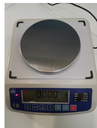
Рис.11 Весы лабораторные ВК-150.1
