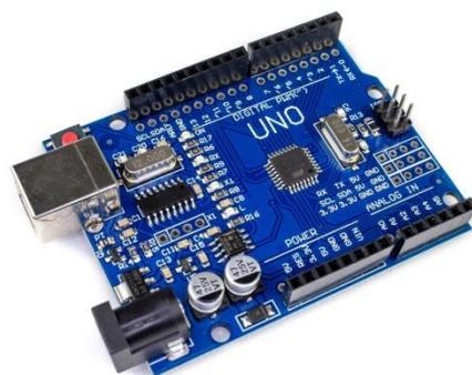
Рисунок 2. Плата Arduino UNO
