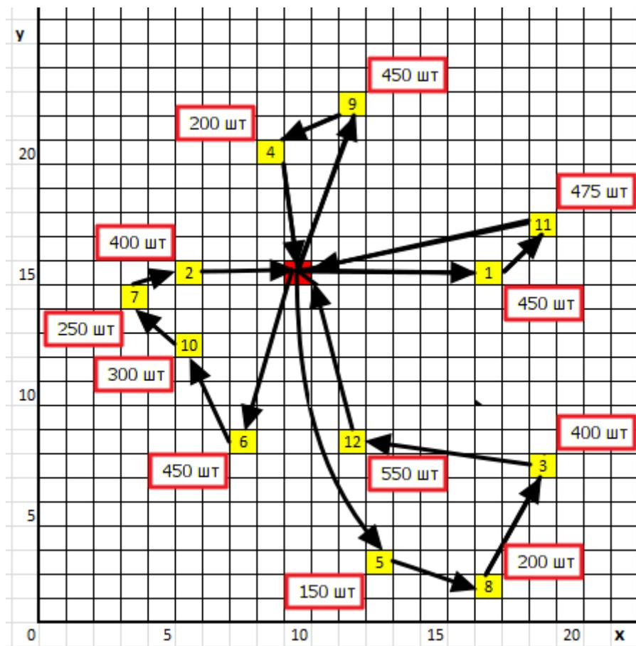
*Рисунок 4. Графическое представление оптимальной схемы доставки*
