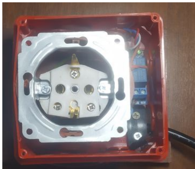
Рисунок 3.2. Реле и розетка, вид внутри
