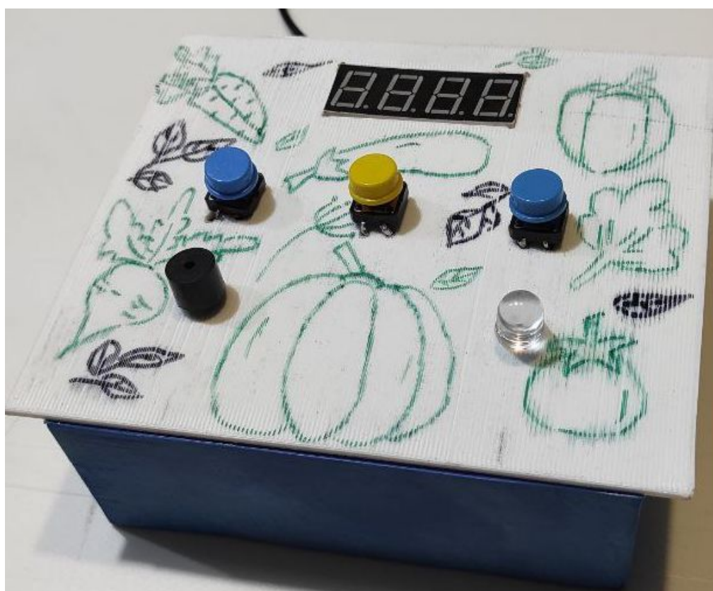
Рисунок 3.3. Второй корпус системы автоаматики (3D), внешний вид
