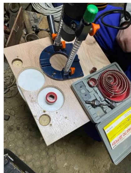
Рис.2. Выпиливание заготовок для статора и ротора
