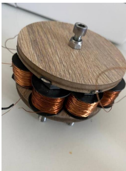
Рис.5. Соединение деталей генератора
