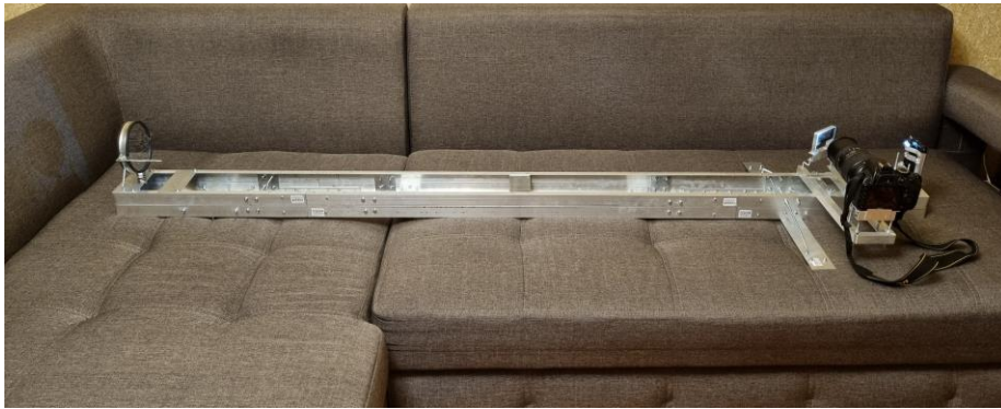
Рис. 7. Создание оптического устройства с использованием шлирен (теневого) метода
