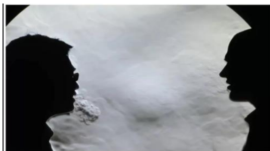
Рис.4. Испытание медицинских масок.
