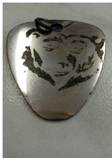
Фото 4. Результат травления в опыте 2
