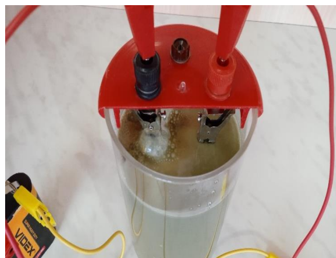
Фото 8. Выделение газа на катоде.
