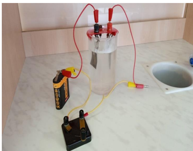
Фото 7. Прибор для опытов по химии с электрическим током
