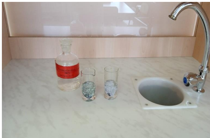
Фото 2. Травление заготовок в соляной кислоте
