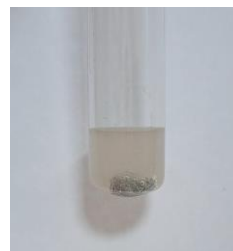
Рис 2. Взаимодействие цинка с конц. \text{H}_2\text{SO}_4
