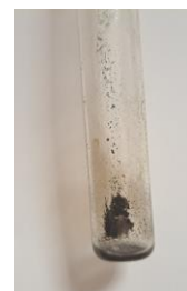
Рис 6. Отбор части черного осадка после реакции между медью и конц. \text{H}_2\text{SO}_4
