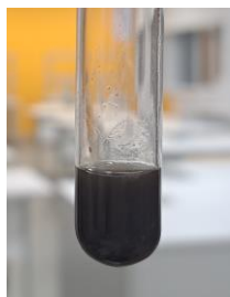
Рис 5. Образование черного осадка в ходе реакции между медью и конц. \text{H}_2\text{SO}_4
