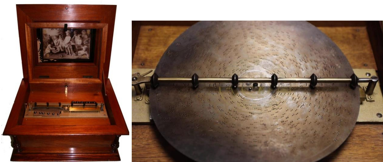
Рис. 1, Symphonion model №30 и его носитель – перфорированный диск.
