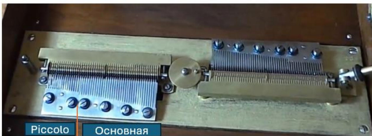
Рис. 6, гребёнки полифона Symphonion model №30
