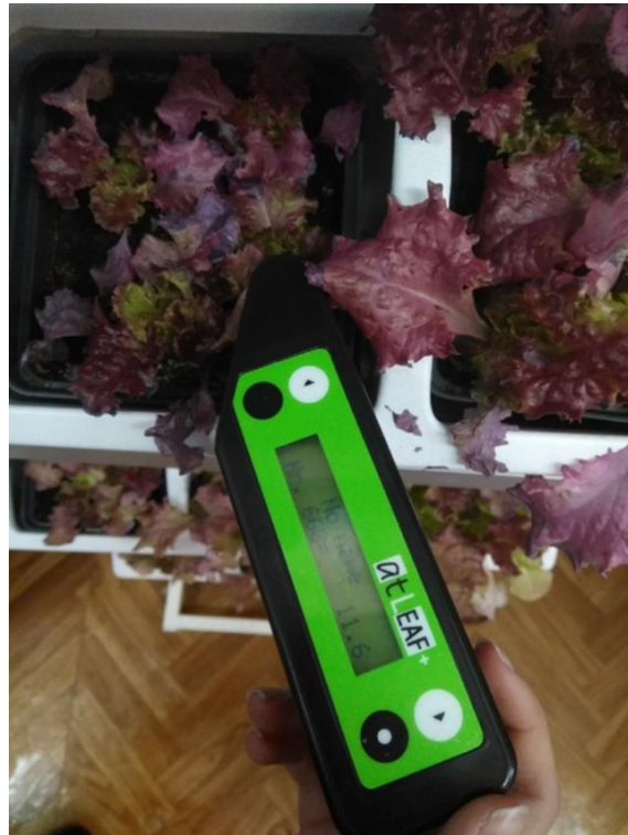
Рисунок 7 – Определение содержания хлорофилла в листьях салата листового экспресс-методом
