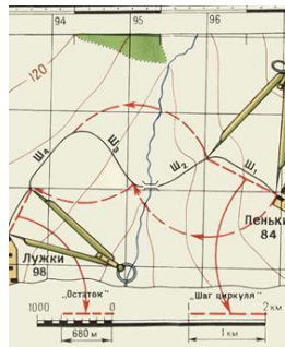
Рис. 4. Измерение на карте расстояний циркулем-измерителем по извилистым линиям
