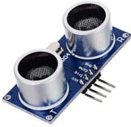
Прибор бесконтактного типа, обеспечивает высокоточное измерение и стабильность. Диапазон дальности его измерения составляет от 2 до 400 см. На его работу не оказывает существенного воздействия электромагнитные излучения.
