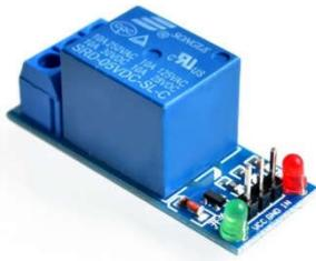
Релейный модуль на 1 канал. Напряжение питания модуля 5В. Управление от микроконтроллера. Один нормально замкнутый и один нормально разомкнутый контакт реле. Модуль обеспечивает коммутацию переменного тока с напряжением 220В и постоянного тока до 30В. На плате модуля расположен светодиодный индикатор, сигнализирующий включение реле.
