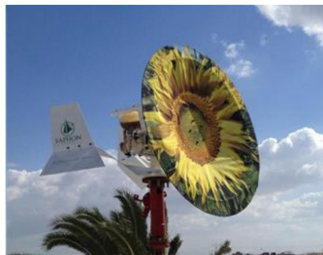
Рис. 12. Ветрогенератор устроенный по типу парусника.
