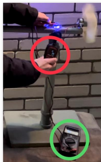
Рис. 22. Зависимость напряжения от силы ветра
