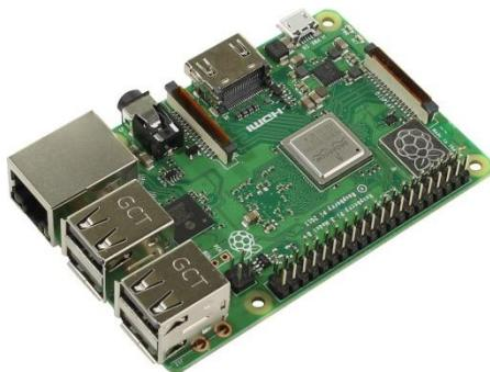
Raspberry Pi 3 Model B+ - это одноплатный компьютер с 4-ядерным 64-битным процессором с частотой 1.4ГГц, 2-полосной беспроводной LAN 2.4ГГц и 5.0ГГц, Bluetooth 4.2/BLE, Ethernet.
